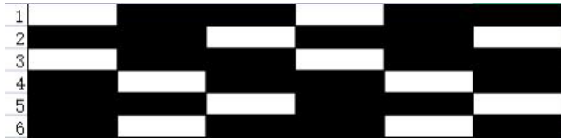
图 3.4 仿生机器人四足步态的腿部相位图
